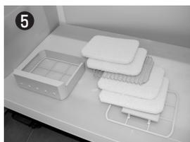
5 交換の場合は、二次フィルタ、スペースアミ、一次フィルタの順にセットします。一次フィルタ(2枚)、二次フィルタ(2枚)は、「ミストレーサ純正品」とスタンプがある方を下流側(風下側)にして、1枚ずつ取り付けてください。(一度に入れるとかたよる可能性があります。)
