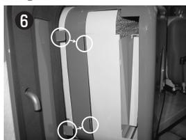
6 フィルタ交換が完了し、フタを取り付ける際、必ずガイドをガイド穴に差し込んで取り付けてください。正しく取り付けしていない場合、油が漏れる原因となる可能性があります。
