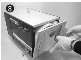
吐出側のクランプを外してバックパネルを取り外すと、エンドフィルタが現れます。
