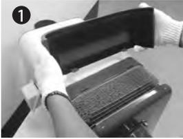
1 拆下夹子，拆卸下盖子。
