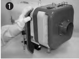
1 拆下夹子，拆卸下盖子。
