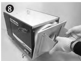
拆卸下排出侧的夹子，并拆卸下后部面板后，可见终端过滤器。
