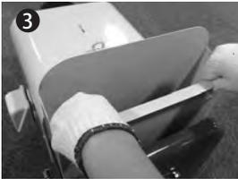
3 进行排液部的检查时，拆卸下盒式除雾器后，将除雾器盒子取出到上部。
