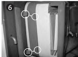
过滤器更换完毕，安装盖子时，请务必将导轨插入到导孔中进行安装。如果没有正确安装，则有可能导致漏油。
