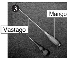
Para desatornillar el cilindro exterior e instalar el marco para filtros, use un destornillador largo (vastago de 200 mm o mas). Destornilladores mas pequeños pueden no alcanzar los tornillos si el mango se queda atascado.
