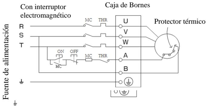
b) Ejemplo de conexión usando el interruptor opcional de genuine product (con un térmico 3SW y cable de 3 m incluidos)
