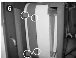
6 Al recolocar la tapa, inserte las pestañas en la ranura de guía. Una tapa mal colocada puede causar fugas.
