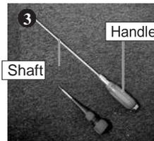
Para desatornillar el cilindro exterior e instalar el marco para filtros, use un destornillador largo (vástago de 200 mm o más). Destornilladores más pequeños pueden no alcanzar los tornillos si el mango se queda atascado.
