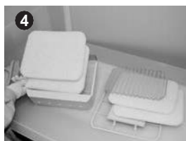
4 Retire primero los filtros primarios (finos), luego la red espaciadora, por último los filtros secundarios (gruesos).
