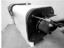
Introduzca el demister/filtro final en el marco para filtros y cierre la tapa trasera atornillandola de nuevo. (Para los modelos S, coloque la costura del filtro final mirando hacia abajo.)
