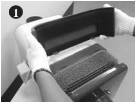
Abra los cierres y retire la tapa.
