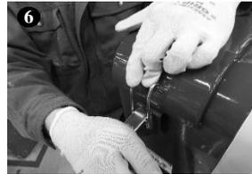
Para fijar la tapa a la caja del filtro, como se muestra en la foto, mientras sostenga con una mano brazo de la abrazadera junto a la tapa, se incline la palanca. (\*Asegure que el brazo esté bien colocado.)
