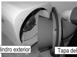
Desatornille la tapa trasera y retirela, teniendo así acceso a el cilindro exterior ubicado en el cuerpo de Mistresa y a la tapa del cilindro exterior colocada en la tapa trasera.
