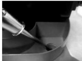
Cuando reemplace o revise los filtros o demisters, compruebe la existencia de virutas en los orificios de drenado. Si se encuentran virutas, retirelas con la mano o usando una varilla de no mas de  $\varnothing 8$  mm de diámetro. Cualquier obstrucción puede impedir que el aceite se drene adecuadamente.
