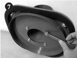
Modelos S: Desatornille el codo y la tapa trasera.
