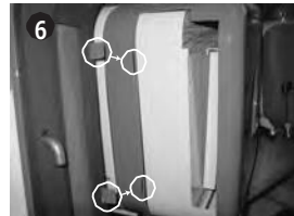
필터를 교환하고 뚜껑을 덮을 때, 반드시 가이드를 가이드 구멍에 넣고 덮어주십시오. 바르게 덮이지 않은 경우 기름이 새는 요인이 됩니다.
