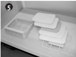
교환할 때, 2 차필터, Space 망, 1 차필터 순으로 설치합니다. 1 차필터(2 매), 2 차필터(2 매)는 「미스트레사순정품」 스탬프가 있는 쪽이 아래를 향하도록 하고, 1 매씩 넣어주십시오. (한번에 다 넣을 경우 한쪽으로 치우칠 수 있습니다.)
