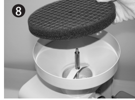
拆卸下终端过滤器，进行更换。
