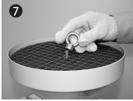
请拆卸下吊环螺母。
