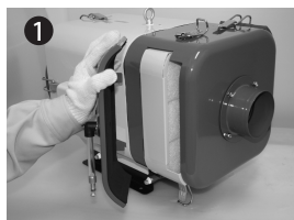
拆下夹子，拆卸下盖子。
