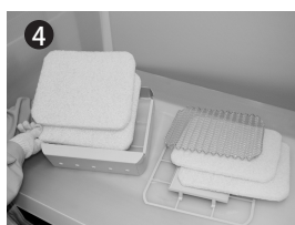
按序拆卸下一次过滤器（薄的部分）、间隔网、二次过滤器（较厚的部分）。
